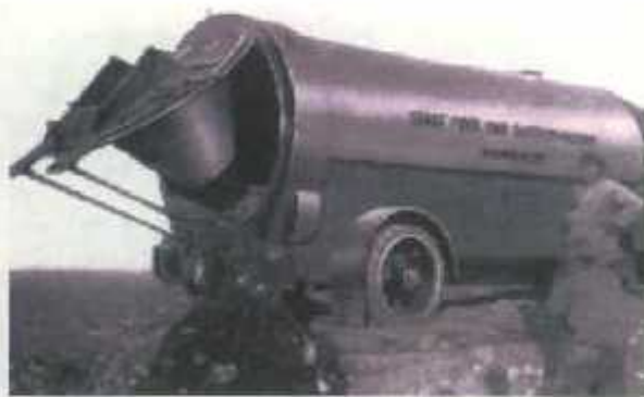
خودروی جمع آوری دوار از سال ۱۹۲۸-۲۰۰۲ ساخت شرکت های Kukka و Faun که بدون تغییرات اساسی بیش از ده هزار دستگاه از آن ساخته شد. (برلین - سال ۱۹۲۹)
