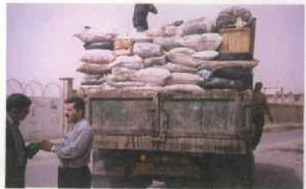
تصویر ۳. نمونه‌ای از خودروهای غیراستاندارد جمع آوری زباله (پرت شدن زباله و احتمال سقوط کارگر)
